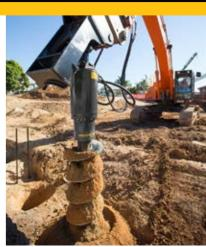
**SUITABLE FOR 8 - 22 TONNE EXCAVATORS**
